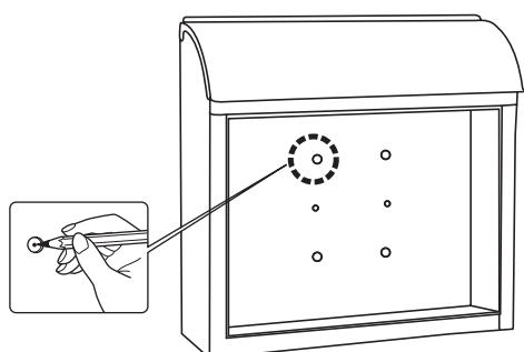
2 壁面にドリル径 5mm で下穴を開けます。
