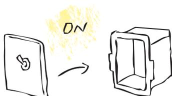
すでに施工済みの住宅の場合、スイッチを取り外してみると壁にはプレートサイズの穴が空いており、その下に配線がある構造をしています。アクシスオリジナルのプレートタイプスイッチは、国内スイッチボックスの基準サイズに対応しているので一度空いてしまった壁の穴もすっぽり隠すことができます。
