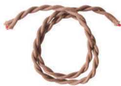
HS2368 ツイストコード カット売り 580円 (税込638円) ※1メートル単位での販売です。 【コード規格】 芯線数/2本 芯線の公称断面積 /0.75mm 2 使用温度の上限値/75℃ 電圧/250V 外被材質/PVC ※「ひし形PSE」取得済み。
