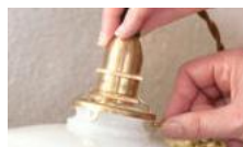
シェードの首に3本爪パーツを 合わせ、外しておいたネジで 固定します。
