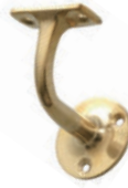
HR115P ※ 階段ブラケット プラス 4,200円 (税込4,620円) サイズ/約w50 × d70 × h70mm 台座部分/約直径50mm 耐荷重/90cm間隔に手摺取付時150kg、ブラケット単体 180kg 素材/真鍮 ※真鍮ネジ付
